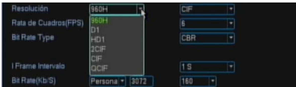
Imagen 2 - Según el modelo de DVR la opciones de resolución van desde 960H hasta QCIF
